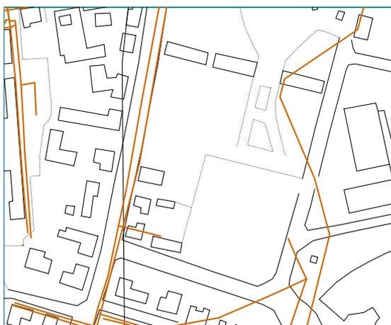
Un apposito elaborato allegato al progetto individua inoltre l'attraversamento indicativo di altri sottoservizi, quali cavidotti (per linee elettriche e di pubblica illuminazione) e condotte di acqua e gas, che potrebbero interferire con la realizzazione della rampa di raccordo del sottopasso entro il recinto ospedaliero.
